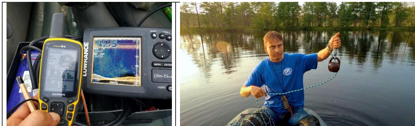
Рис. 13. Промеры глубин озера Красный Остров в 2022 году с помощью эхолота, навигатора и лотинья
